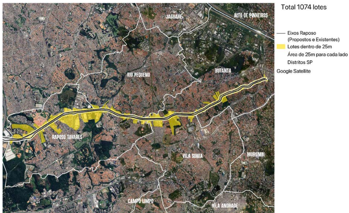
Figura 4. Total de lotes afetados - contabilizados em uma distância de 25 m dos eixos propostos
