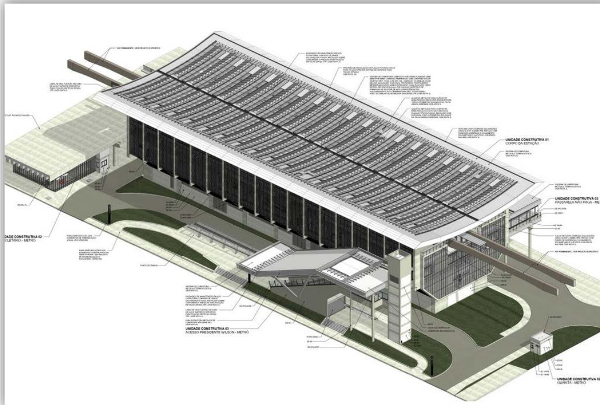
Cobertura da estação com painéis fotovoltaicos
